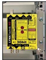
RFR 1200 最多可安装 14 个 yellobrik 模块。此外，它还可以在电源故障时提示全电源冗余和 GPIO 警报。
