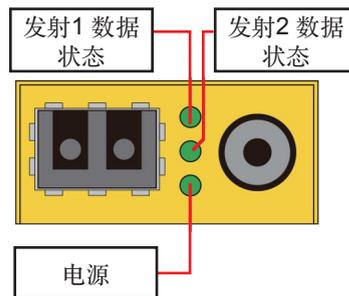
警告: 无论 LED 如何指示, 只要连接电源, 模块激光器就会激活
