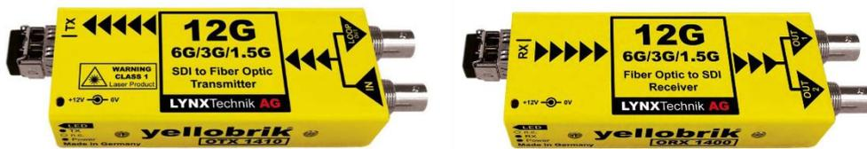
OTX 1410 & ORX 1400 是一对紧凑型 SDI 光纤收发器，专为长距离传输非压缩分配，高带宽，广播级品质视频信号而设计。是一套符合成本效益的光纤传输/接收系统，视频信号高达 12Gbit/s (4096×2160@60Hz)，保持完整非压缩品质。
