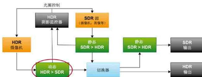
图2: 在摄像机后进行动态转换的 HDR/SDR 制作
