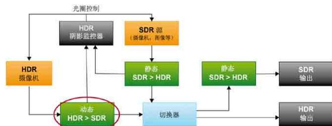
图4：使用HDR摄像机和动态转换进行SDR生产
