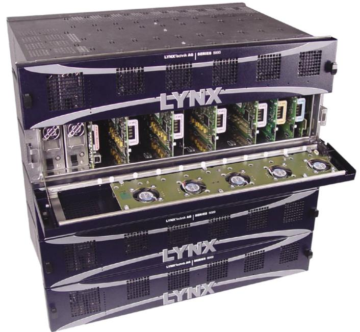
显示铰链打开的机架前面板便于访问所有已安装的设备
