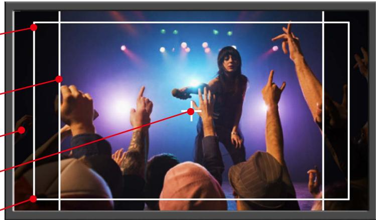
屏显标示能根据应用要求自定义配置。包括各种不同的“标准”安全区域标示，可调节幕透明度的纵横比标示。标示颜色也能自行改变。
